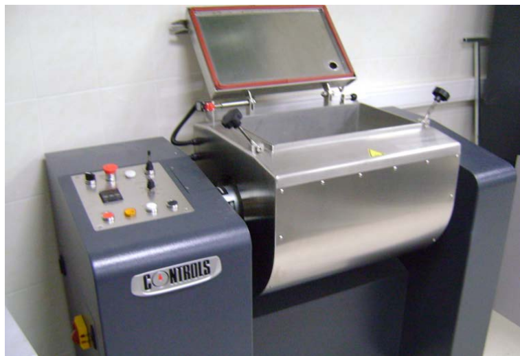
Рисунок 2.1 – Лабораторный асфальтобетоносмеситель Bitumix
