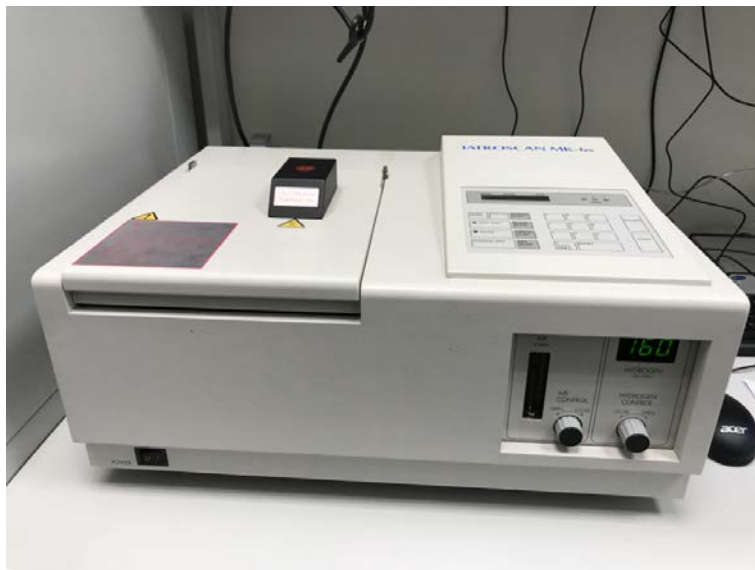
Рисунок 2.5 – Анализатор группового углеводородного состава битумов Iatroscan Mark V
