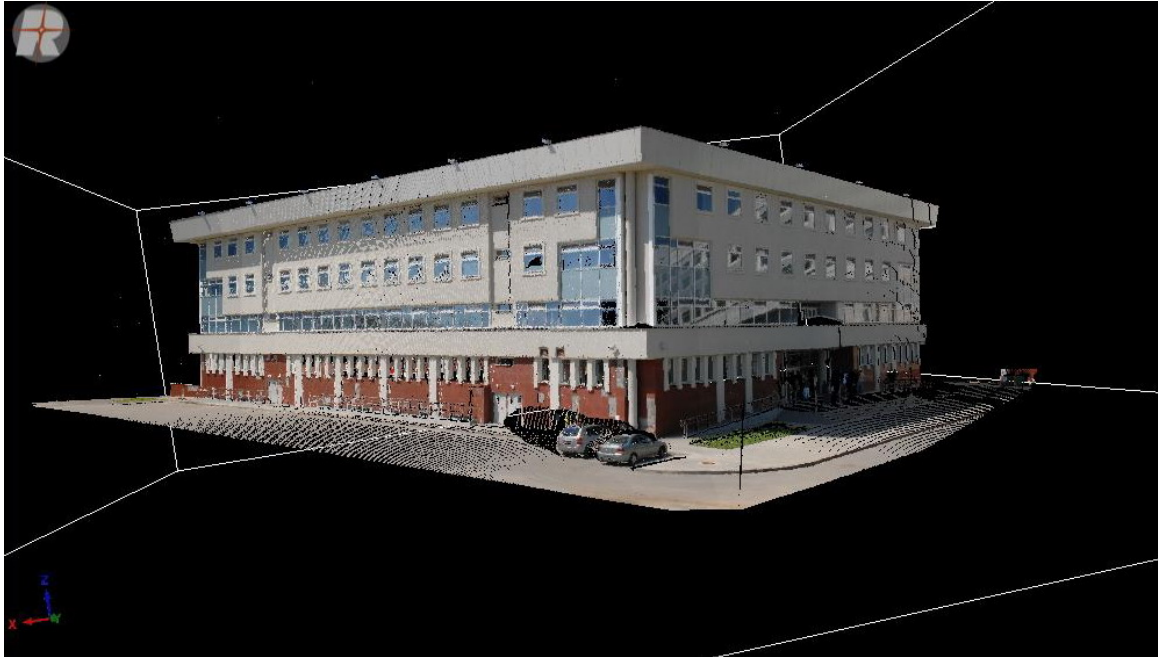
3-D точечная модель здания учебно-лабораторного корпуса МГСУ.
